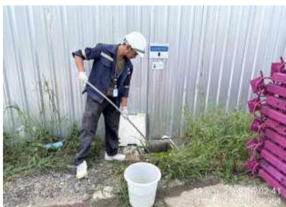
รูปที่ 3-4 รูปแสดงการเก็บตัวอย่างน้ำทิ้ง บริเวณระบบบำบัดน้ำเสียสำเร็จรูป
