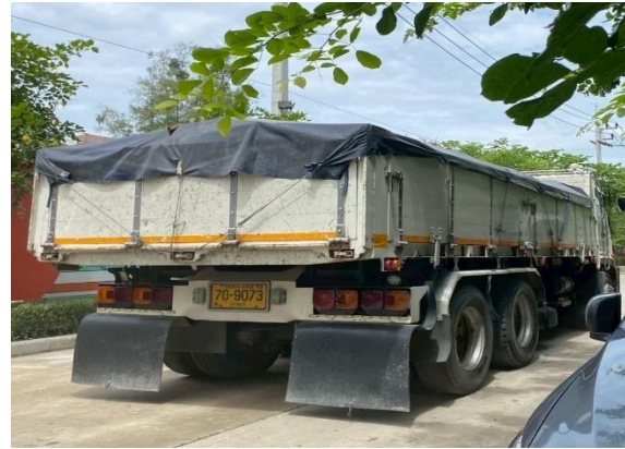
รูปที่ 2-13 การปิดคลุมผ้าใบที่รถบรรทุก
